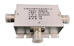
该耦合器用于 50W 以下调频 波 段射频信号功率分路耦合。 采用磁环线圈设计具有驻波比 小、 工作稳定性好。适用于隧 道广播系统直放站(远端机)射 频功率分路耦合输出。
